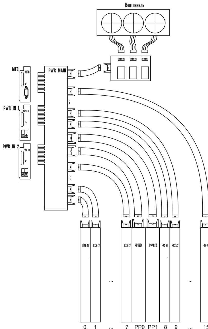
Рисунок 3.4 – Структура системы электропитания в кейте MC1000-PX
