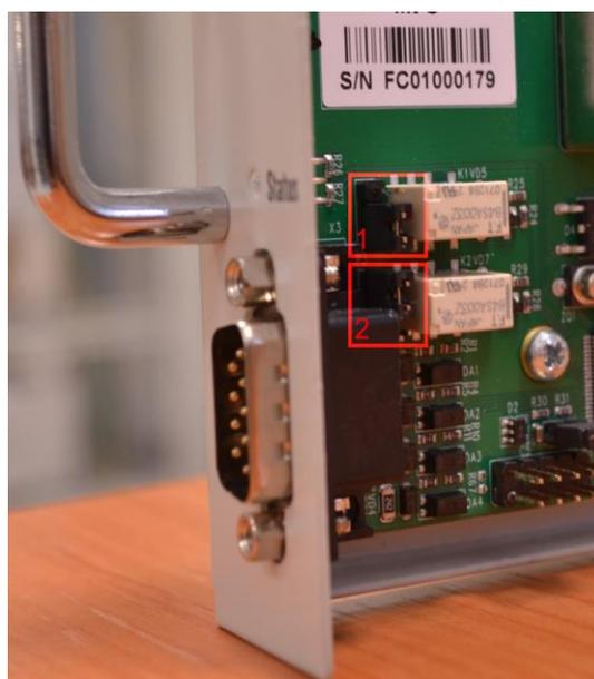
Рисунок 3.5 – Положение перемычек
