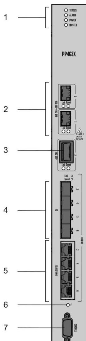
Рисунок 3.8 – Внешний вид передней панели, описание разъемов, индикаторов и органов управления модуля PP4G3X
