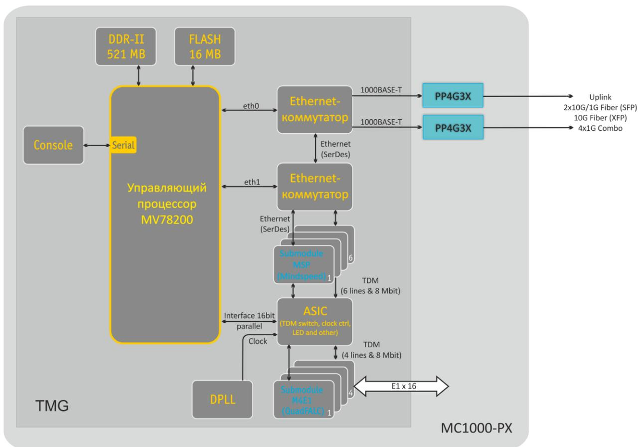
Рисунок 4.3 – Функциональная схема TMG-16
