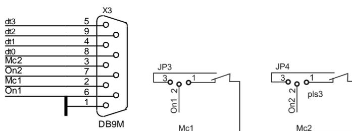
Для подключения датчиков и исполняющих устройств следует использовать кабельную розетку DB9. Может быть подключено до четырех датчиков и двух исполнительных устройств.
