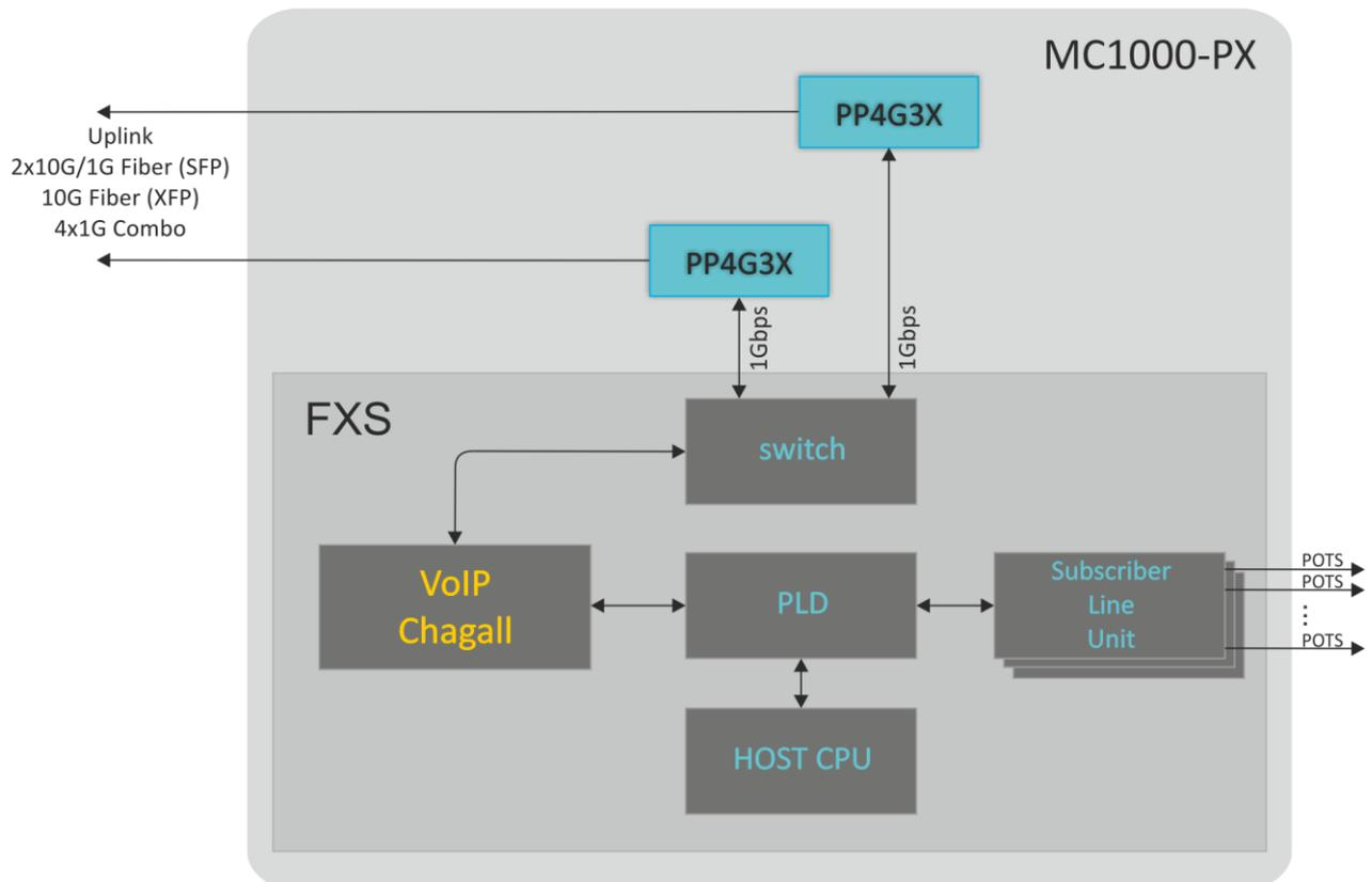
Рисунок 4.2 – Структурная схема модуля FXS
