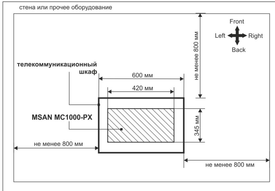
Рисунок 5.2 – Пример размещения оборудования в аппаратном зале
