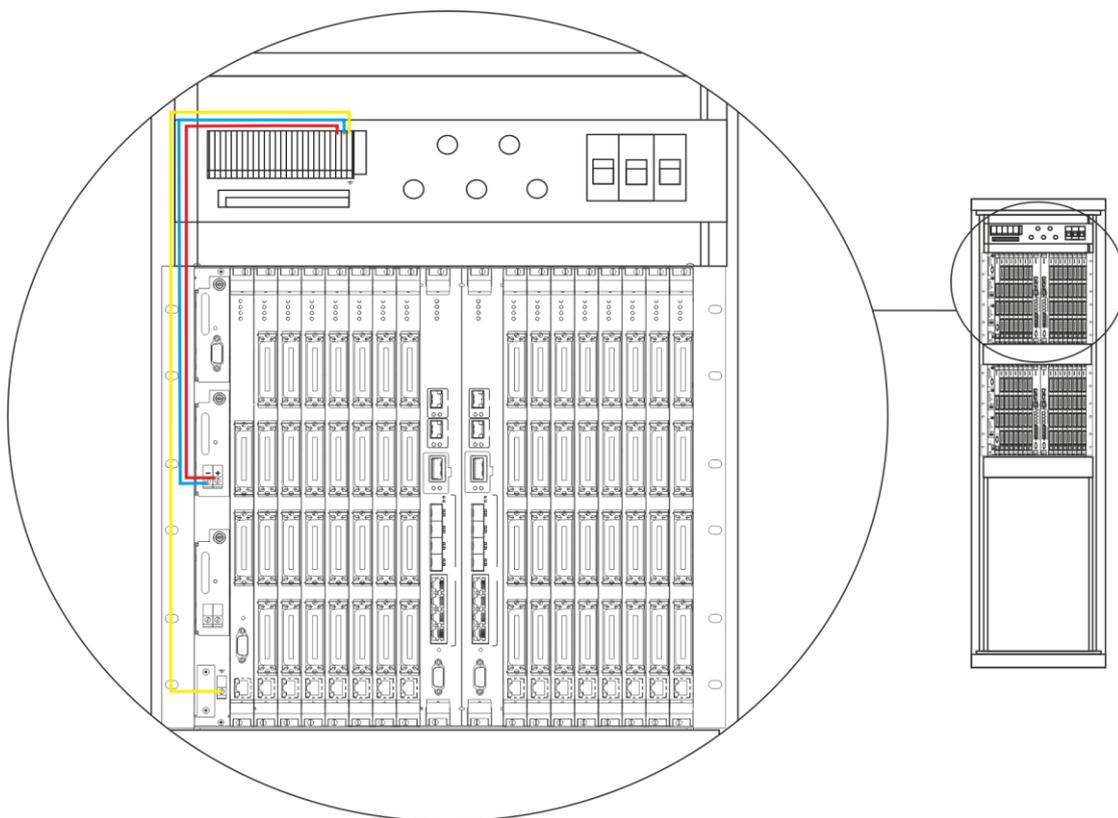
Красный – провод, соединяющий клемму «+» устройства с положительным полюсом источника питания;
